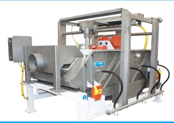
Los **separadores rectangulares MultiMotion** son apropiados para **procesos líquidos**, combinando la tecnología de movimiento lineal y elíptico, optimizando la clasificasión y la vida útil de la malla al **incrementar o disminuir las fuerzas de gravedad** wcon un simple interruptor.
